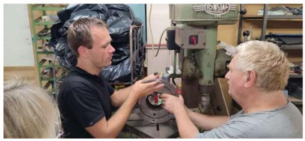
En tenant compte de la hauteur des cales, le dictionnaire technique donne une valeur de réglage de 59,8 mm entre le bas des cales et la surface de contact des linguets. Ici c'est la table de la perceuse qui sert de marbre
