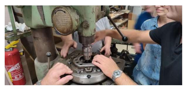
On met ensuite le mécanisme plusieurs fois en pression en le comprimant avec le mandrin, pour libérer les contraintes et mettre en place toutes les pièces. La butée est intercalée sous le mandrin :
