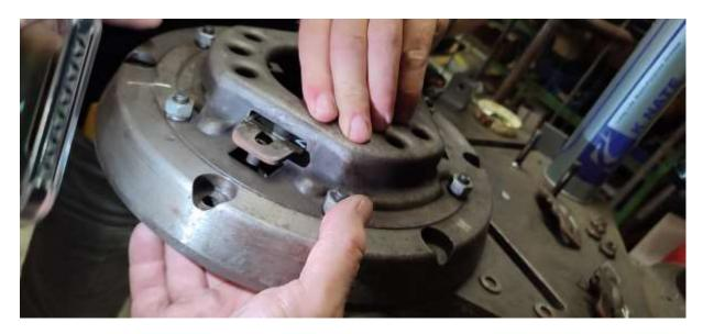
Pour les linguets, bien vérifier l'état des 3 vis et écrous, et remonter les rondelles d'origine :
