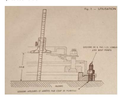
Comme nous n'avions pas de jauge de profondeur sous la main, Adrien a fabriqué une pige calibrée pour bloquer le mandrin de la perceuse à la bonne hauteur. On règle ensuite les linguets pour les amener au contact du mandrin :
