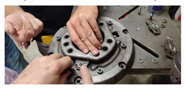
Pour mettre le mécanisme en tension, comme il le sera sur le moteur, on vient visser 3 cales usinées qui vont repousser le plateau de manière uniforme, ce qui simule la pression qui sera exercée ensuite par le disque lorsqu'il sera remonté :
